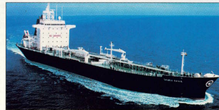
El tanquero de la nueva línea Double Eagle lleva hasta 56.000 m 3 de petróleo.
