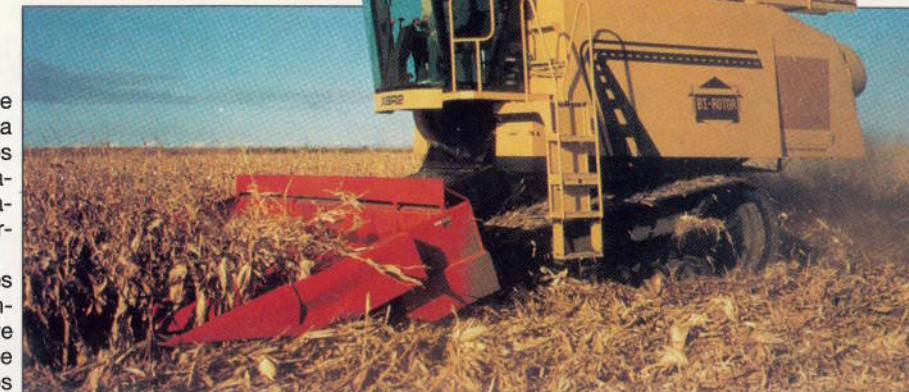
La compacta trilladora del Bi-Rotor se caracteriza por tener el tanque para los granos dos veces más grande que el normal, es capaz de albergar 14,4 m 3 (400 bushels).
