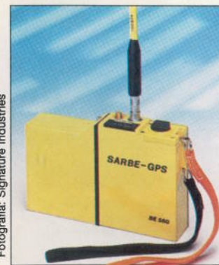
La guía de rescate GPS transmite latitud, longitud y el código de identificación de seis dígitos.
